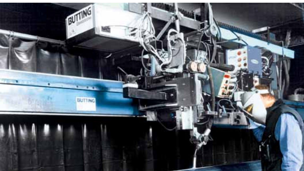
Produzione di un tubo per forno fatto in lega di Nicrofer® 6025HT/602CA con CRONIGON® Ni30. (Fonte: H. BUTTING GmbH & Co. KG)
