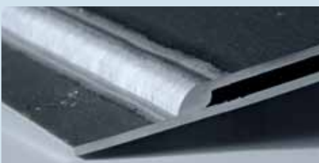
Saldatura AC-MIG con VARIGON® He15S su lamiera di spessore 1 mm e gap 1,5 mm
