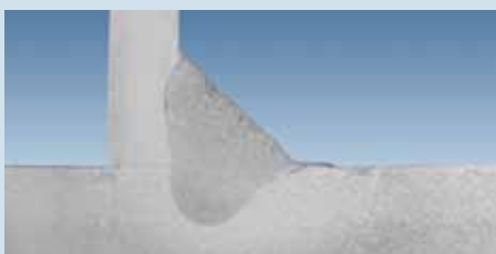
Stabilità direzionale dell'arco MIG con VARIGON® He30S su spessori diversi, giunto a T su lamiera 3 mm con 8 mm
