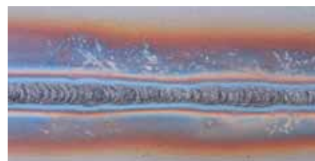
Retro del cordone di saldatura senza protezione a rovescio
